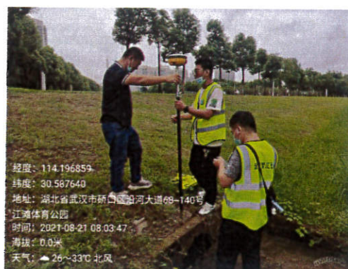
(b) RTK 测量排水口高程
